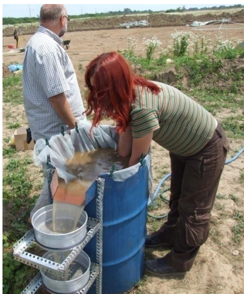
Slika 8. Najčešće korišteni model flotacijskog uređaja na terenu (foto: Andreja Kudelić)
