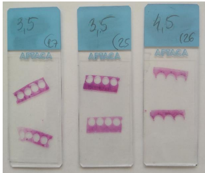
Slika 46. Fotografija histoloških rezova uzoraka goveđih kosti obojenih hematoksilinom i eozinom
