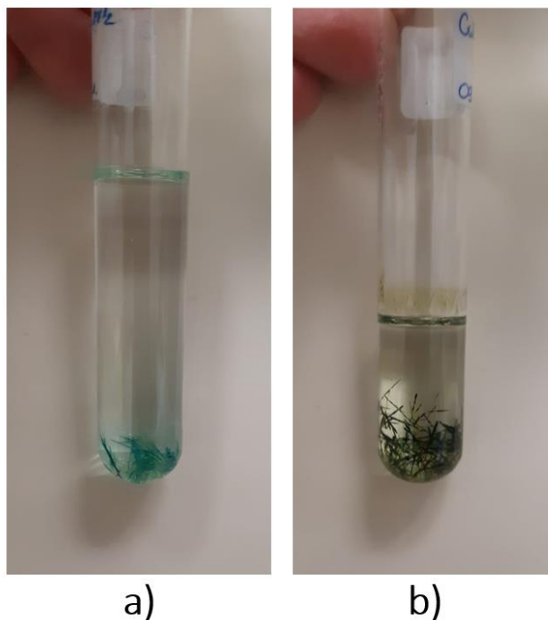
Slika 28. Jedinični kristali koordinacijskih polimera bakra(II): a) [\text{CuCl}_2(3\text{-NO}_2\text{py})_2]_n ( 1 ), b) [\text{CuBr}_2(3\text{-NO}_2\text{py})_2]_n ( 2 ).
