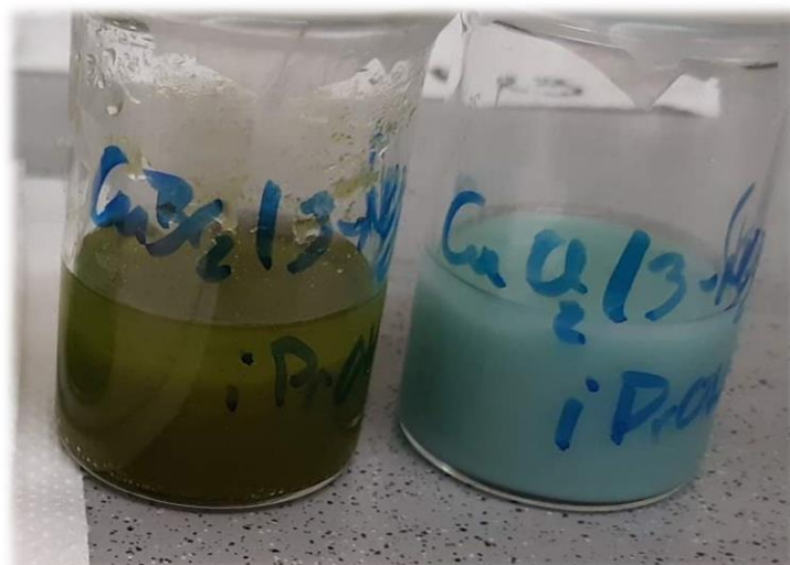
Slika 26. Sinteza praškastih uzoraka koordinacijskih polimera 1 (desno) i 2 (lijevo).
