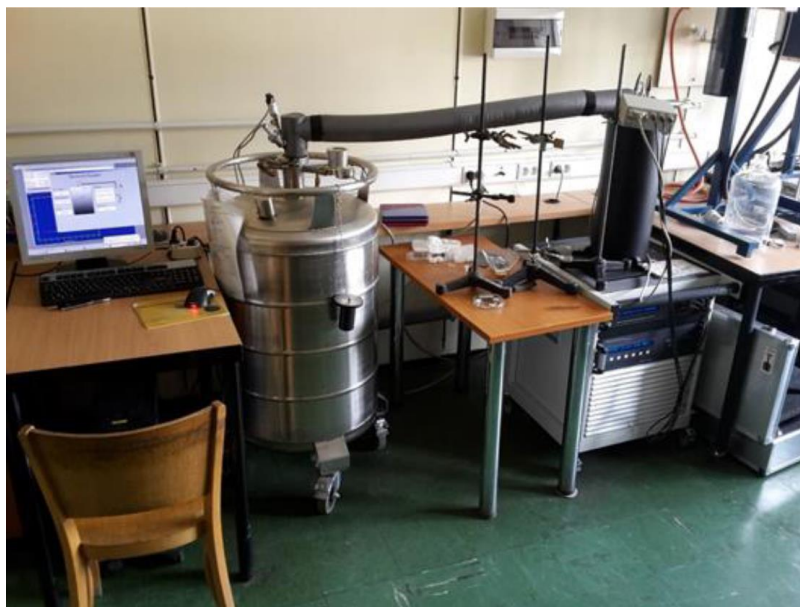
Slika 33. Sustav za impedancijsku spektroskopiju u Laboratoriju za funkcionalne materijale, IRB.
