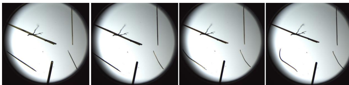
Slika D21. Mikroskopija grijaćom pločom kristala spoja [\text{CuBr}_2(3\text{-NO}_2\text{py})_2]_n ( 2 ) u rasponu temperatura od 30 do 200 °C s brzinom zagrijavanja 2\text{ °C min}^{-1} .
