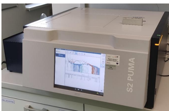
Slika 20 XRF mjerni postav, Bruker S2 PUMA.
