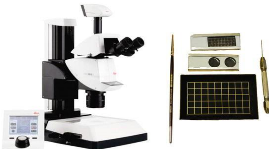
Slika 4: Oprema korištena za mikropaleontološku analizu- stereoskopska lupa, mikropaleontološka plitica, igla.
