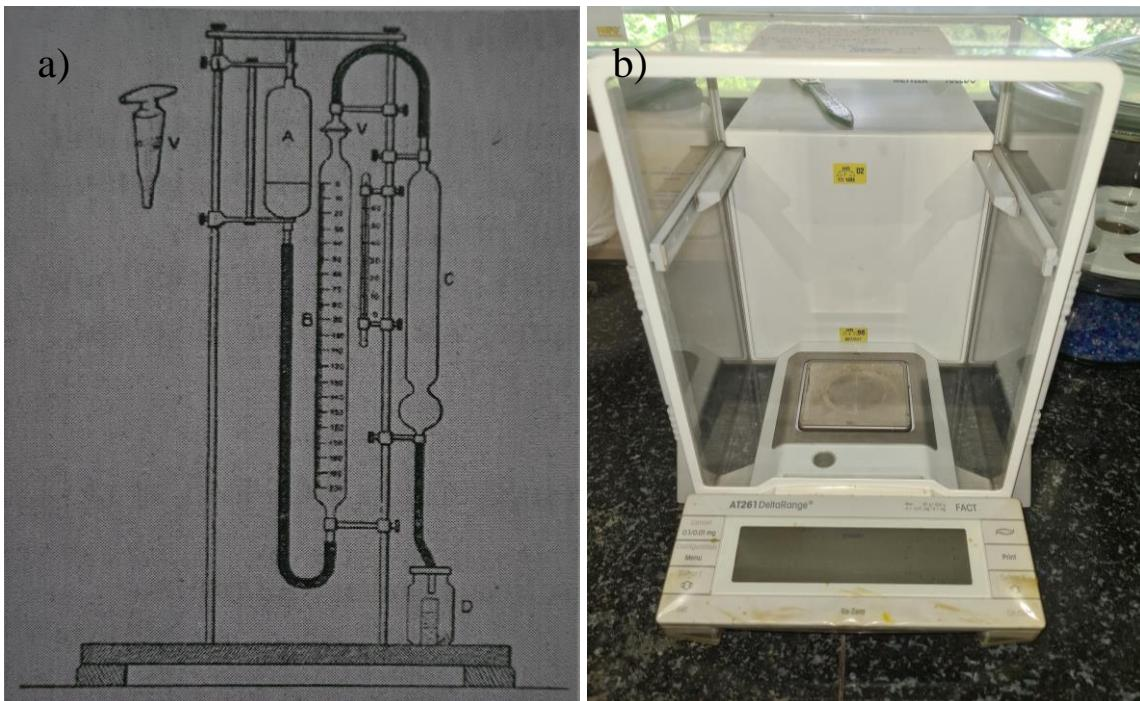
Slika 13. a) Shematski prikaz Scheiblerovog kalcimetra gdje pokretna cijev A služi za izjednačavanje tlaka tijekom rada, cijev B je graduirana i koristi se za očitanje oslobođenog CO<sub>2</sub>, a na vrhu joj se nalazi ventil V preko kojeg je u kontaktu s cijevi C koja je fiksna i spojena na posudu D ili tikvicu u kojoj se nalazi uzorak za analizu na miješalici za miješanje uzorka. b) Digitalna vaga „Metler“ za odvagu uzorka.
