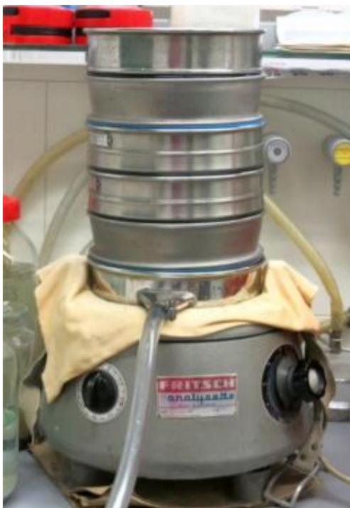
Slika 10: Tresilica i set sita za mokro sijanje
