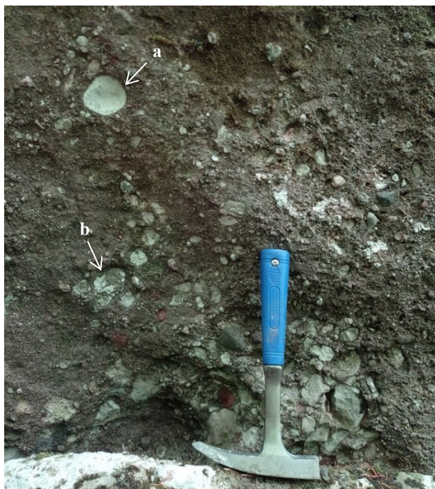
Slika 11. Matrikspotporni konglomerat; a – dobro zaobljeno sferično zrno, b – loše zaobljeno slabo sferično zrno
