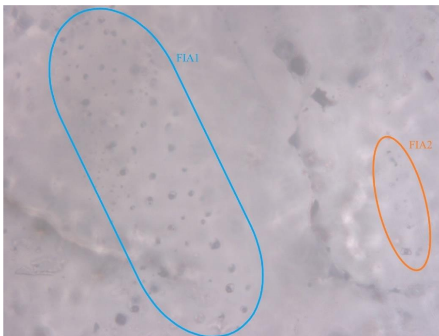
Slika 43. Prikaz FIA podtipa fluida 1; FIA1 predstavlja L+V+S+O tipove inkluzija, dok FIA2 predstavlja L+V tipove inkluzija. Uzorak B11, povećanje 40x
