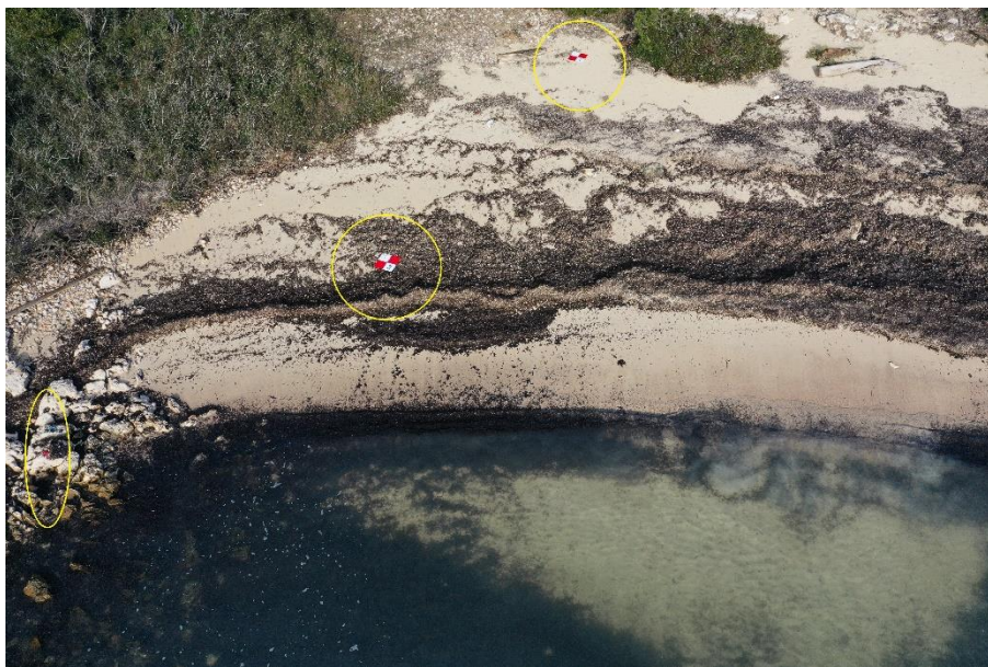
Slika 8: Metalne ploče i crvene točke korištene kao pomični, odnosno fiksni markeri tijekom snimanja plaže.
