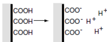
Slika 5. Shematski prikaz nabijanja površine koloidne čestice mehanizmom disocijacije (preuzeto i prilagođeno iz izvora 10)
