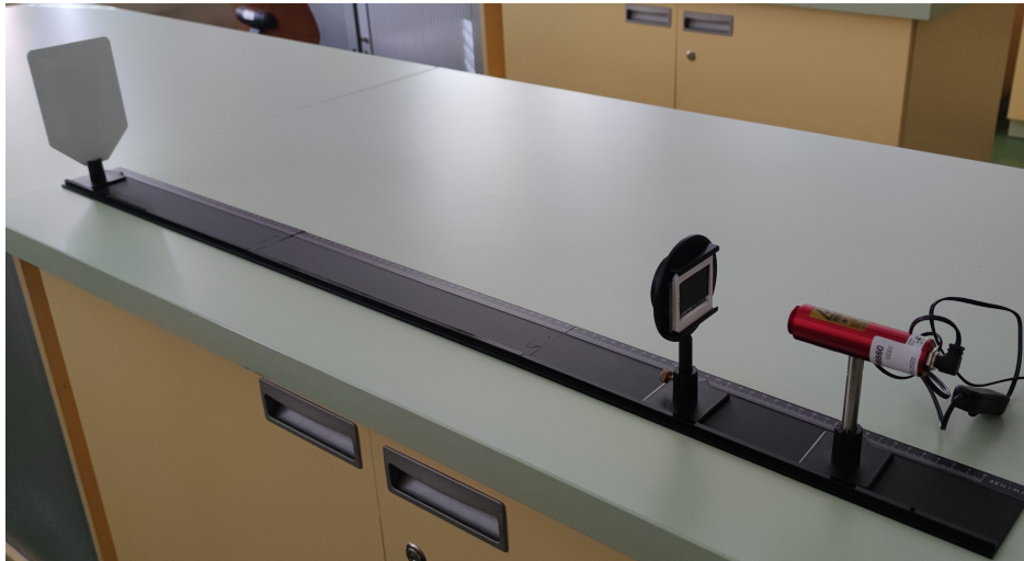
Slika 6.6: Postav učeničkog istraživačkog pokusa za istraživanje interferencije i ogiba
