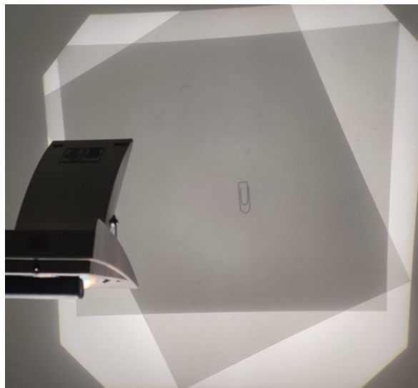
Slika 6.28: Svjetlost grafoskopa kroz dva polarizatora koja su pod kutem manjim od 90 stupnjeva
