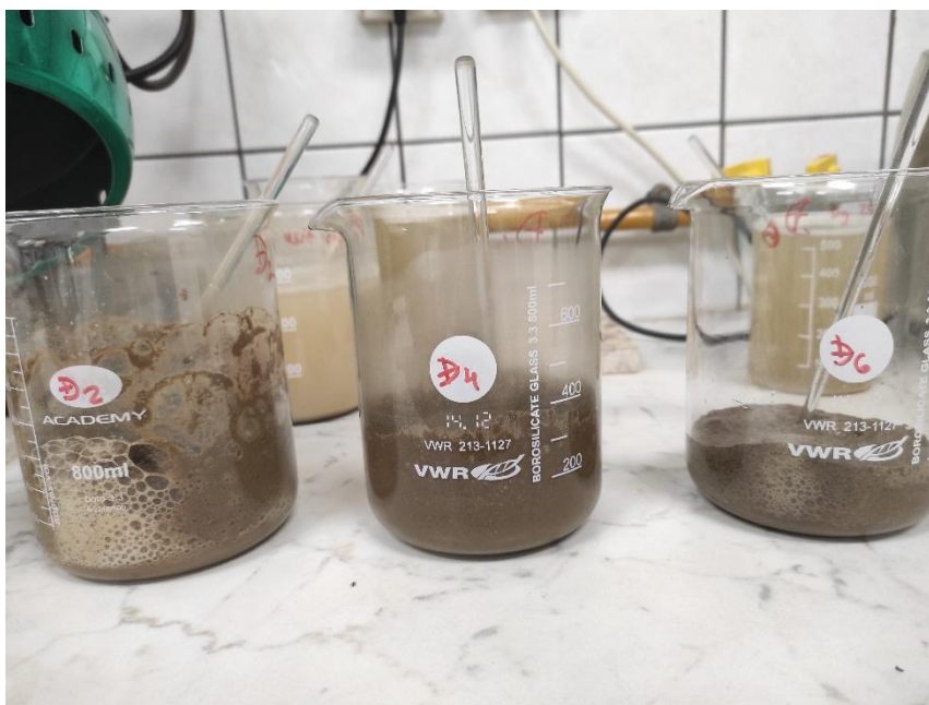
Slika 20. Uklanjanje karbonata iz uzoraka reakcijom s H_2O_2 , Laboratorij Mineraloško-petrografskog zavoda, PMF
