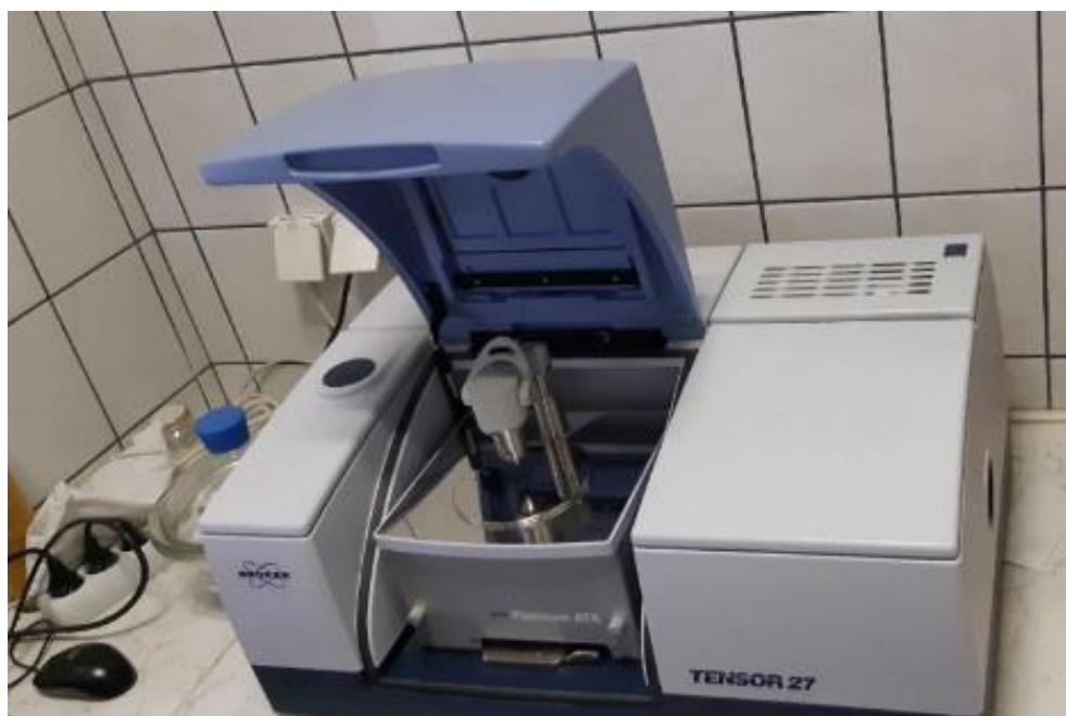
Slika 17. FTIR spektrometar u Laboratoriju Mineraloško-petrografskog zavoda, PMF
