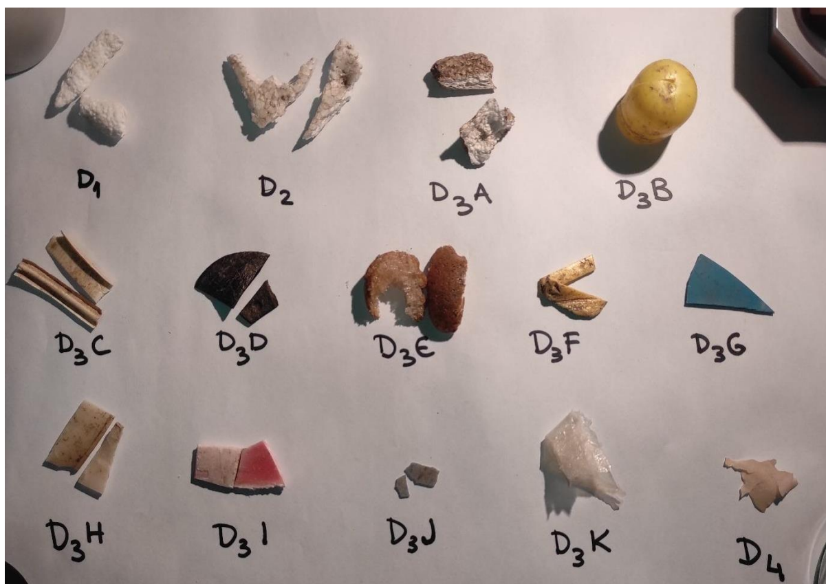
Slika 18. Uzorci mezoplastike korišteni za voltametriju i kasnije za identifikaciju na FTIR-u, Laboratorij Mineraloško-petrografskog zavoda, PMF
