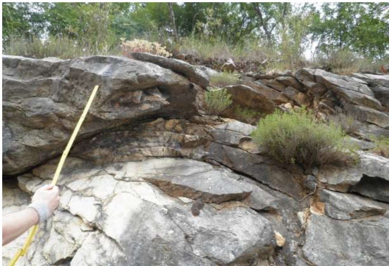
Slika 4. Mjerenje debljina slojeva na istraživanom profilu oznake TG (slojevi s izraženim nepravilnim, valovitim slojnim plohamama).
