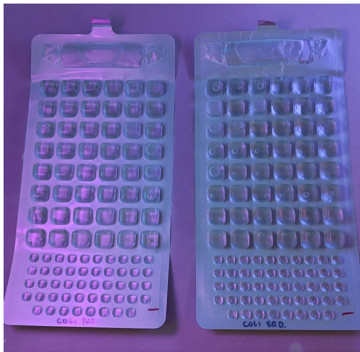
Slika 3.5. Quanti – Tray 2000 (IDEXX, SAD) sastavljen od 97 jažica.
