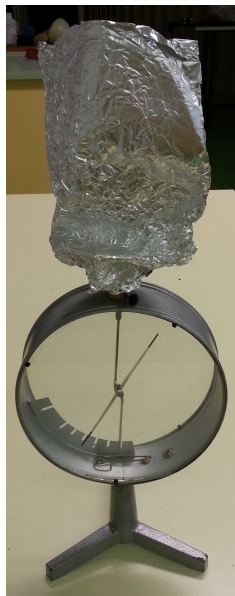
Slika 5.2: Elektroskop s aluminijskom folijom
