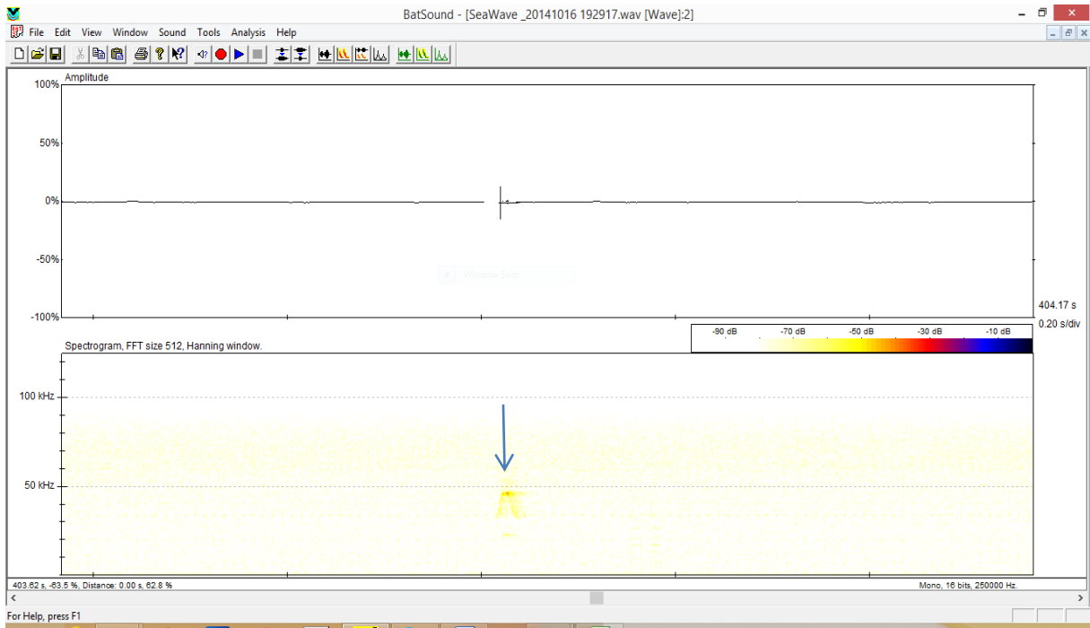
Prilog 2., Slika 2.: Podtip A2 unutar tipa A (označen strelicom). Gornji prikaz predstavlja oscilogram (x-os-vremensko trajanje, y-os-postotak oscilacije), a donji spektrogram (x-os-vremensko trajanje, y-os-frekvencija)
