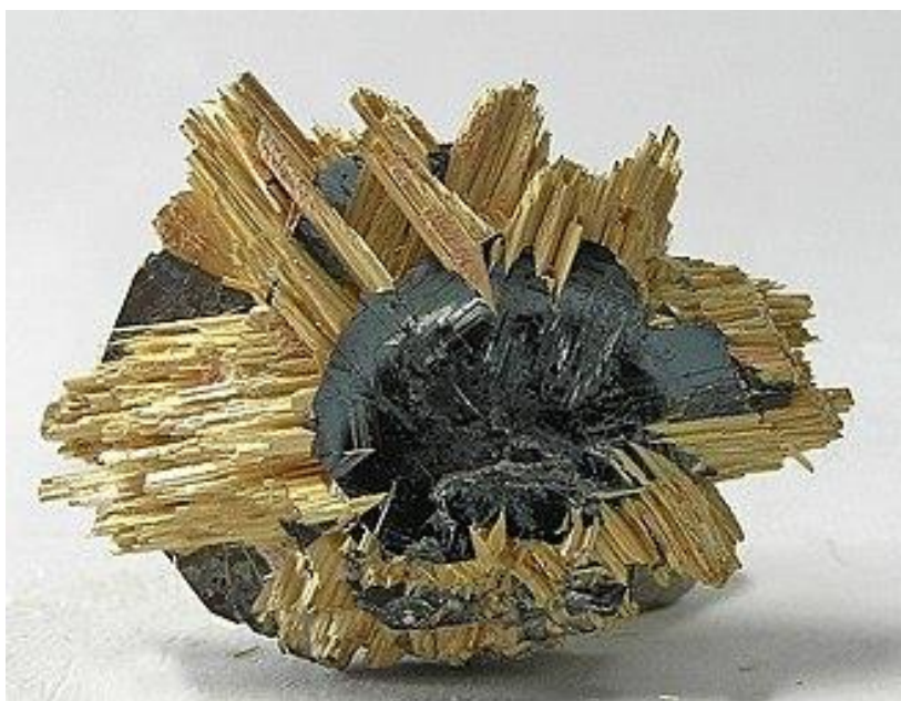
Slika 6. Primjer epitaksije, rast rutila ( \text{TiO}_2 ) na hematitu ( \text{Fe}_3\text{O}_4 ), slika je preuzeta i prilagođena prema izvoru 14
