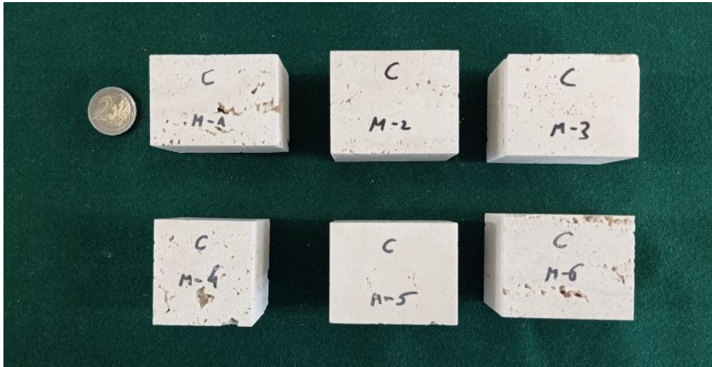
Slika 9. Uzorci travertina nakon 25 ciklusa ispitivanja otpornosti na djelovanje mraza
