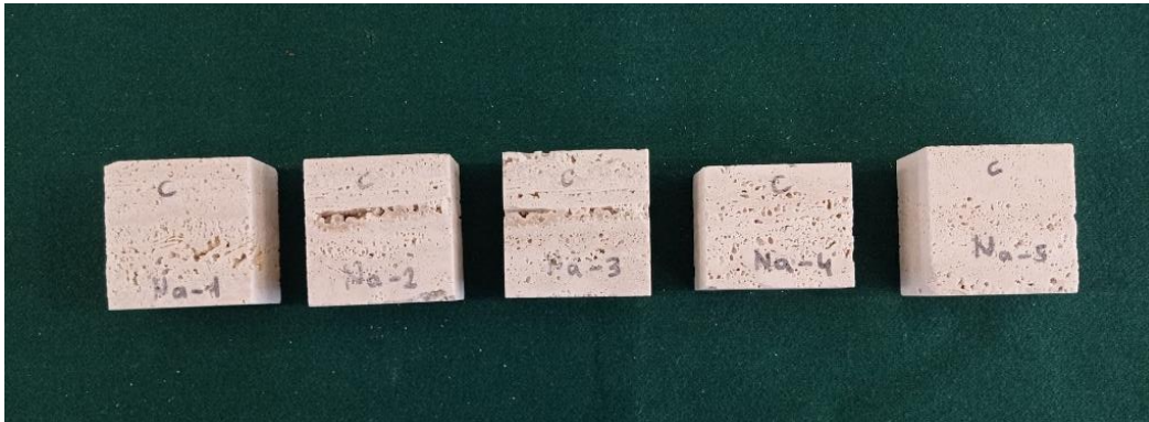
Slika 12. Uzorci travertina nakon ispitivanja postojanosti upotrebom natrijevog sulfata
