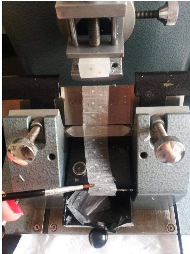
Slika 9: Rezanje parafinskih blokova s uzorcima tkiva sjemenika oštrulja na rotacijskom mikrotomu
