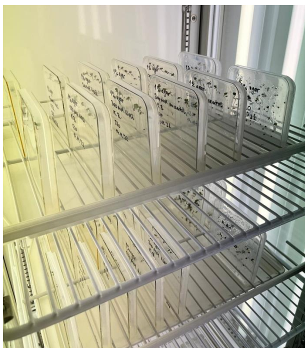
Slika 10. Pločice s klijancima raštike i divljeg kupusa u fitotronu za testiranje inhibicije rasta u uvjetima stresa (solni, osmotski, temperaturni i kombinirani stres).
