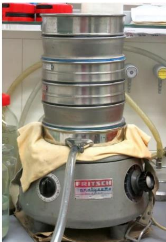
Slika 4.2-1 Retsch® ASTM sita sita od nehrđajućeg čelika različitih veličina promjera otvora posloženi na mehaničkoj tresilici Fritsch Analysette® (Fotografirao: Ivan Lakuš)
