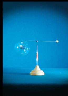
Vrteći rezonator od stakla koji s rastućom snagom zvuka preokrene smjer rotacije 22. 1. 1896.
