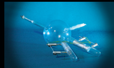
Cijev za negativan naboj katodnih zraka po Gaedeu 3. 4. 1915.
