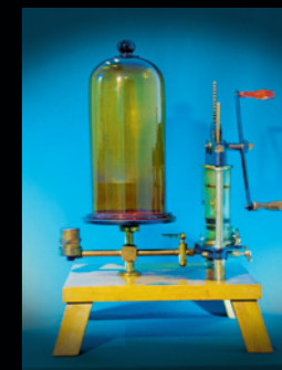
Vakuum puma sa staklenim zvonom Max Kohl, poč. 20. st.
