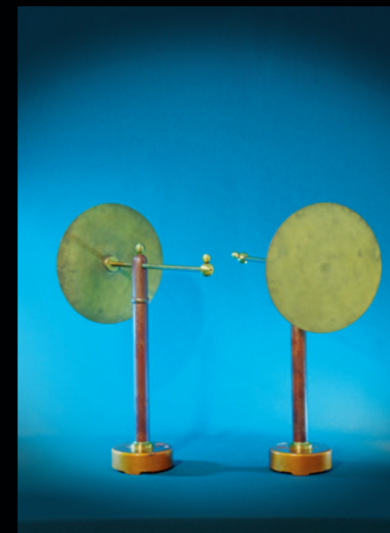
2 kotača od 24 cm za oscilator po Hertzu 8. 5. 1896.
