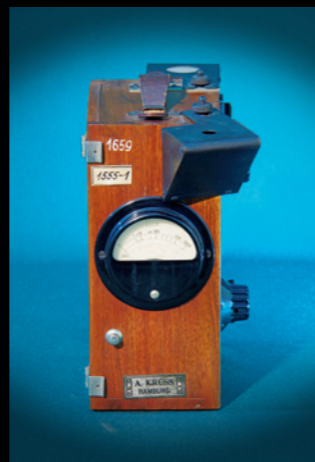
Univerzalni fotometar po Voegu s pripacima 25. 3. 1932.
