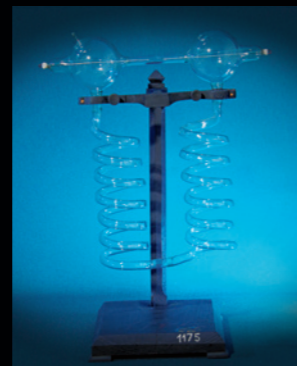
Hittorffova cijev sa stranputicom 29. 5. 1914.
