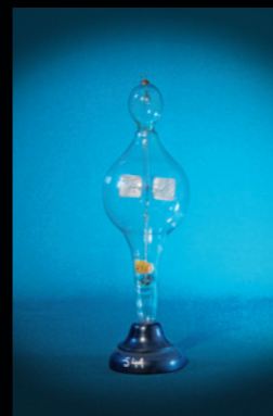
Cijev po Crookesu 11. 12. 1885.
