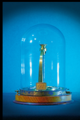
Kovni termometar po Breguetu 30. 4. 1877.
