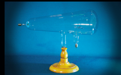
Crookesova cijev s križem 1931.
