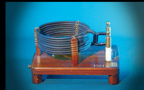
Teslin transformator s uzvojnicom za ugađanje, 1940.
