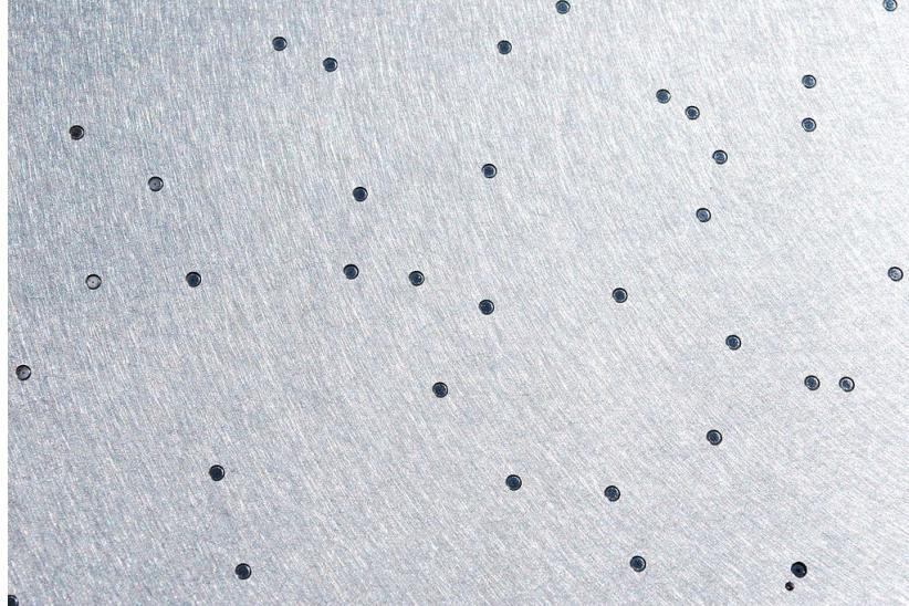
Slika 2.2: Prikaz aluminijске ploče s izbušenim rupama kroz koje su provučena optička vlakna. Fotografija autora EdPost, distribuirano putem CC BY-SA 3.0 licence. [22]
