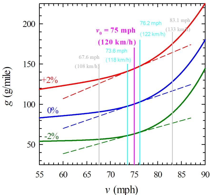
Slika 2.8: Ponovljeni umetak sa slike 2.6, sa zasivljenim brzinama dobivenim korištenjem linearnе aproksimacije, a svjetlo plavo označenim brzinama dobivenim programskim rješenjem
