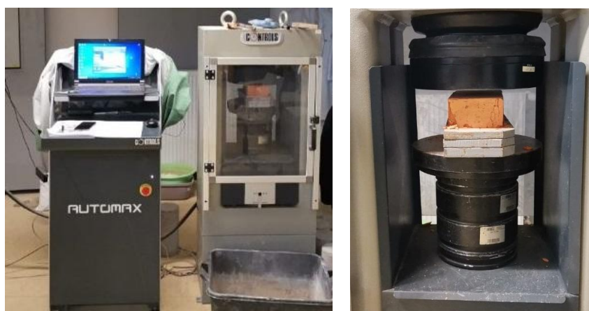
Slika 26. Hidraulična preša za određivanje tlačne čvrstoće.
