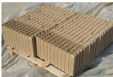
Slika 16. Porotherm glineni blokovi (Wienerberger) prije toplinske obrade i usitnjavanja.
