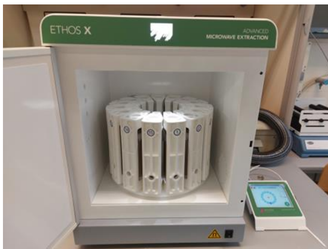
SLIKA 8. Uređaj za mikrovalno potpomognuto razaranje uzoraka.
