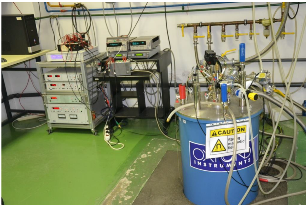
Slika 3.7: 18 T supravodljivi magnet s varijabilnim temperaturnim umetkom.
