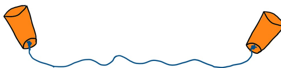
Slika 3.5: Skica jednostavnog žičanog telefona
