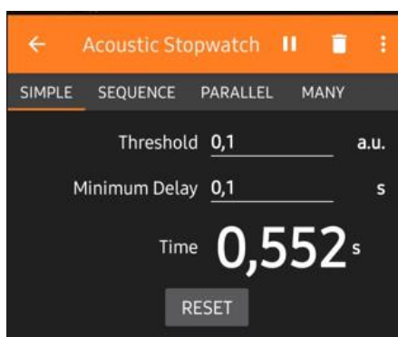
Slika 13 Vrijeme slobodnog pada s visine od 1.5 m
