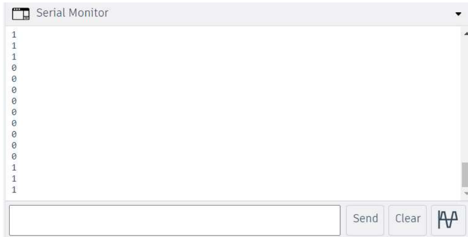
Slika 3.2: Ispis očitanih digitalnih vrijednosti gumba u Serial Monitoru
