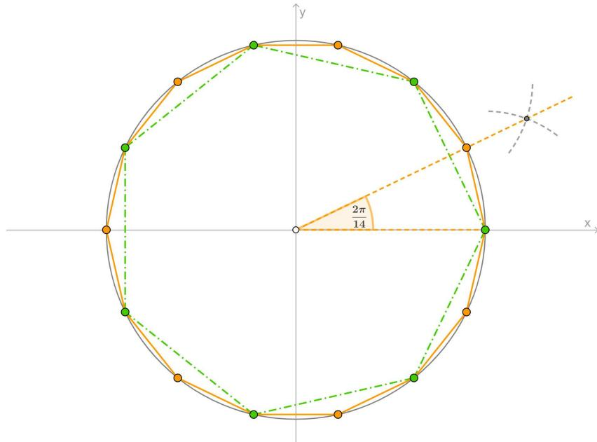
Slika 3.5: Konstrukcija pravilnog četrnaesterokuta
