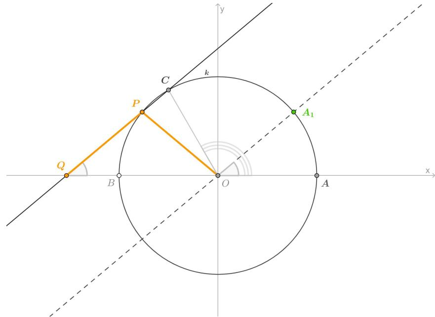
Slika 3.7: Konstrukcija pravilnog deveterokuta
