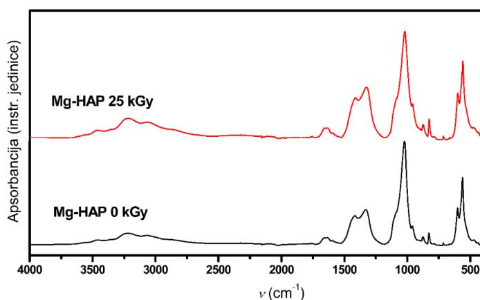
Slika 5.22: Spektri dobiveni infracrvenom spektroskopijom s Fourierovom transformacijom (FTIR) za Mg supstituirani hidroksiapatit (Mg-HAP) za neozračeni uzorak i uzorak ozračen dozom od 25 kGy.
