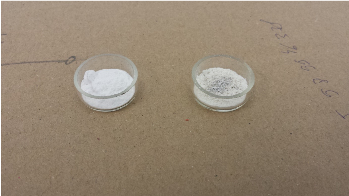
Slika 5.18: Usporedba netretiranog uzorka i uzorka tretiranog RF plazmom
