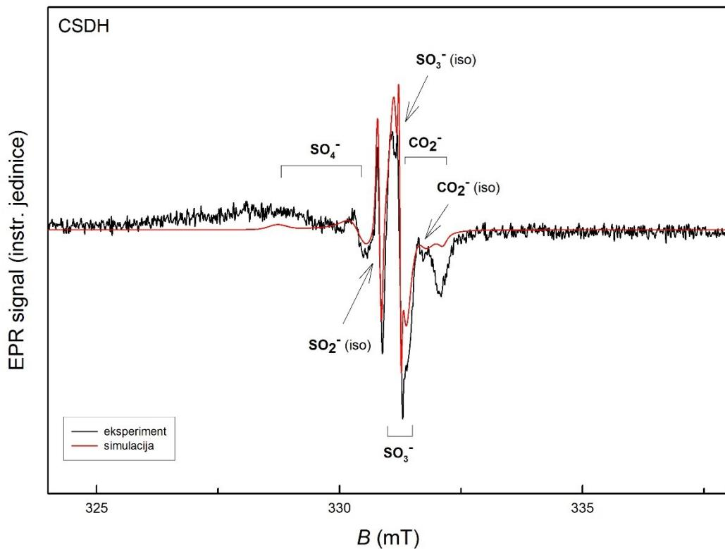
Slika 5.6 : Eksperimentalni (crna linija) i simulirani (crvena linija) EPR spektar kalcijevog sulfata dihidrata – CSDH ozračenog dozom od 25 kGy. Strelicama su označeni radikali inducirani gama zračenjem.
