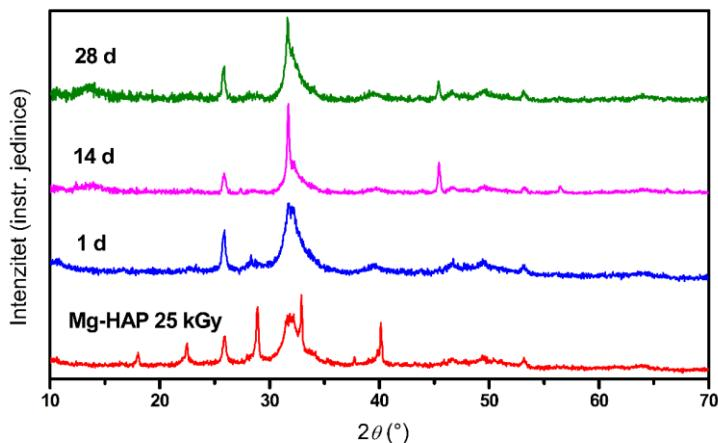
Slika 5.32: Spektri dobiveni difrakcijom rendgenskih zraka (PXRD) za magnezijem supstituirani hidroksiapatit (Mg-HAP) prije i nakon tretiranja simuliranom tjelesnom tekućinom. Prikazani su spektri uzoraka ozračenih dozom od 25 kGy (crvena linija) te uzoraka koji su odstajali 1 dan (plava linija), 14 dana (ljubičasta linija) te 28 dana (zelena linija) pri temperaturi od 37 °C.
