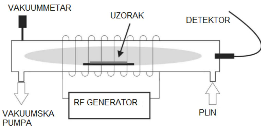
Slika 4.3: Shema eksperimentalnog postava sterilizacije uzorka korištenjem RF plazme.
