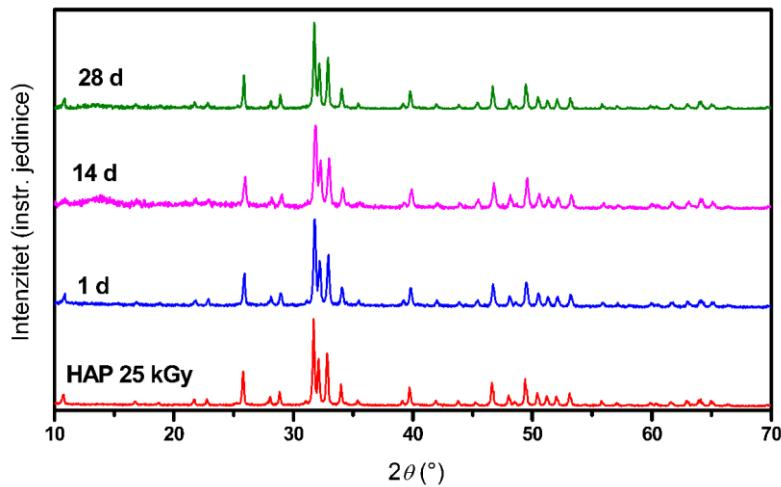
Slika 5.30: Spektri dobiveni difrakcijom rendgenskih zraka (PXRD) za nesupstituirani hidroksiapatit (HAP) prije i nakon tretiranja simuliranoj tjelesnoj tekućinom. Prikazani su spektri uzoraka ozračenih dozom od 25 kGy (crvena linija) te uzoraka koji su odstajali 1 dan (plava linija), 14 dana (ljubičasta linija) te 28 dana (zelena linija) pri temperaturi od 37 °C.
