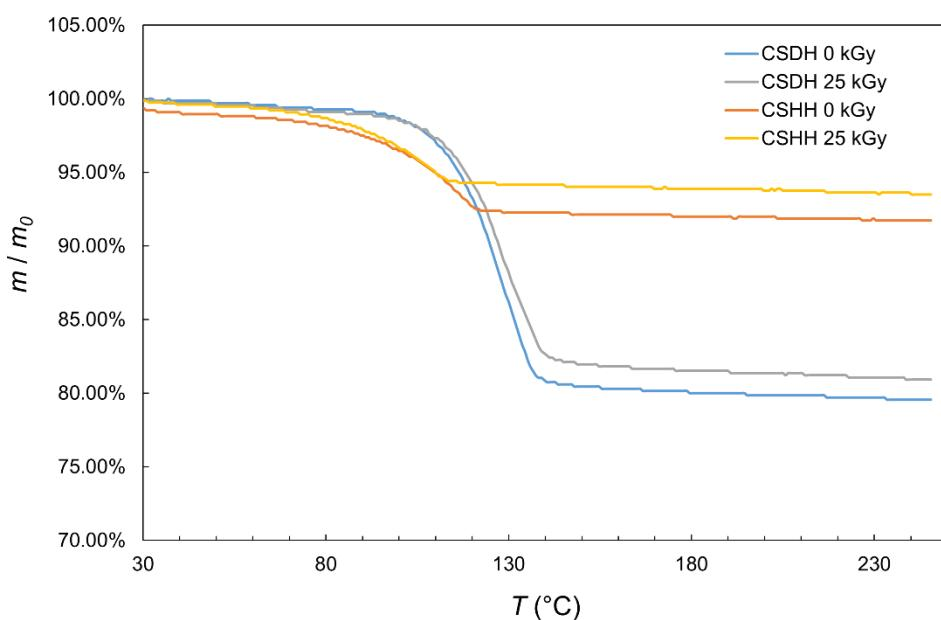
Slika 5.2: Termogrami uzorka kalcijevog sulfata dihidrata – CSDH i kalcijevog sulfata hemihidrata – CSHH. Prikazane su relativne masene promjene uzorka kao funkcije temperature prije (0 kGy, plava i narančasta linija) i nakon (25 kGy, siva i žuta linija) gama zračenja.
