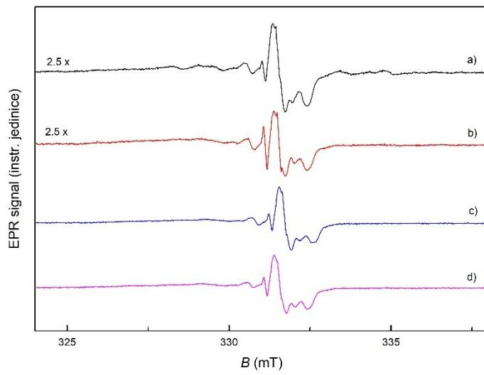
Slika 5.12: EPR signali za a) gama ozračenu mješavinu 40% kalcijevog sulfata dihidrata (CSDH) i 60% kalcijevog sulfata hemihidrata (CSHH), b) s dodanom fiziološkom otopinom, c) s dodanom fiziološkom otopinom i umjetnom slinom, d) s umjetnom slinom
