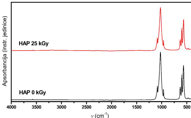
Slika 5.21: Spektri dobiveni infracrvenom spektroskopijom s Fourierovom transformacijom (FTIR) za nesupstituirani hidroksiapatit (HAP) za neozračeni uzorak i uzorak ozračen dozom od 25 kGy.
