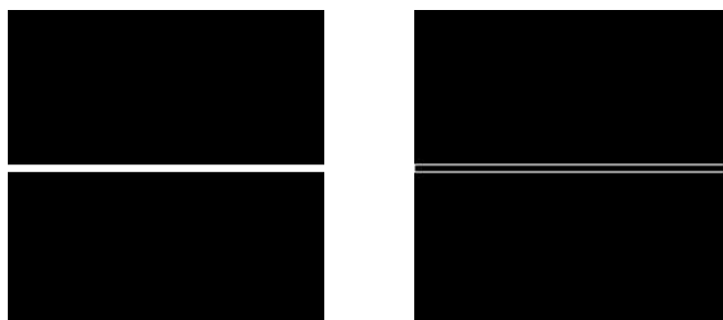
Slika 4.4: Slika linije debljine 6 piksela prije i nakon primjene 3 \times 3 Laplaceovog filtera. Filter je premalen da detektira ovakvu liniju - on vidi unutrašnjost linije kao prostor konstantnog intenziteta, pa se u konačnom odzivu javlja crna crta u središtu linije (tzv. "zero valley").
