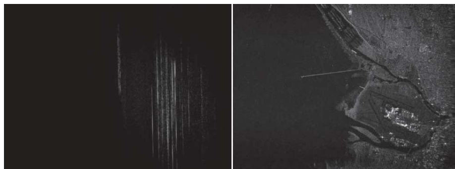
Slika 1.14: Radarska snimka komprimirana u frekvencijskoj domeni (lijevo) i njena rekonstrukcija u prostornoj domeni (desno). Slike su preuzete iz [34].
