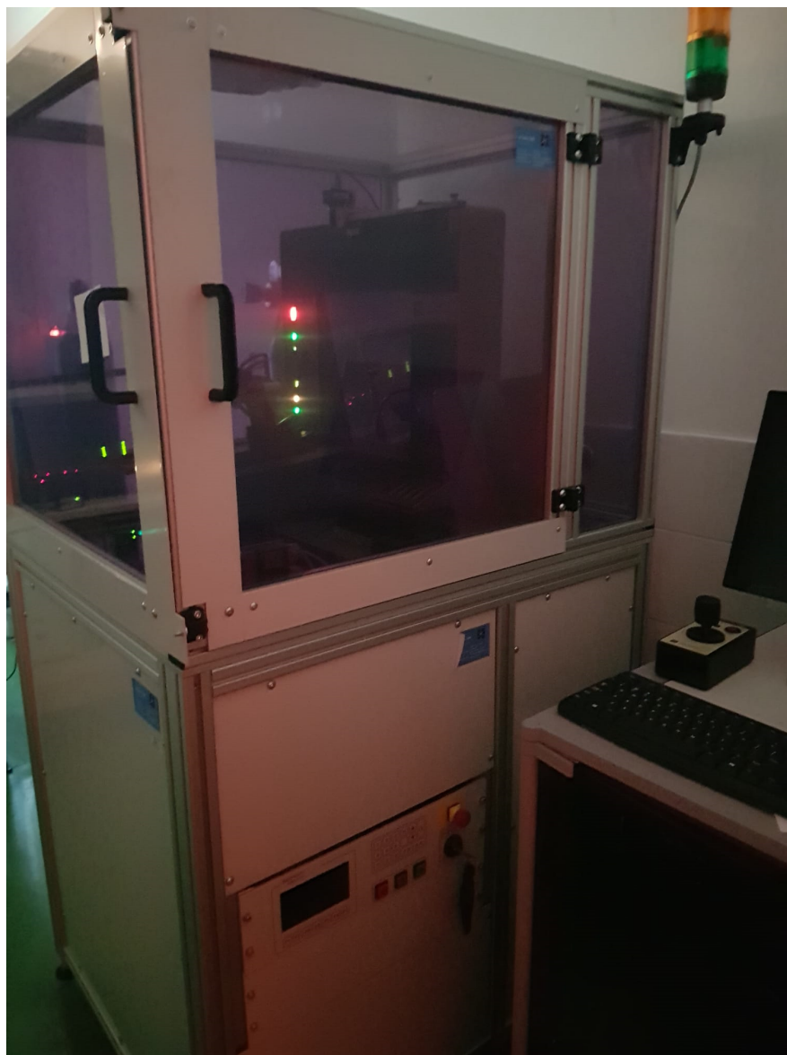
Slika 5.2: Eksperimentalni postav za mjerenje Laueove difrakcije u laboratoriju za mikroskopiju, PMF, Zagreb.
