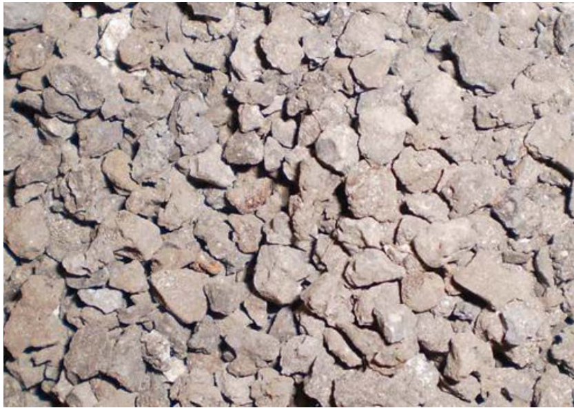
Slika 1. Elektropečna troska iz čeličane Sisak (Foto: Sofilić T.)
