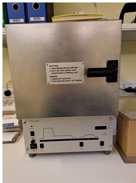
Slika 3.3: Peć za aniliranje i predgrijavanje dozimetara.
