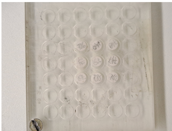
Slika 3.6: Dozimetri TLD-700 u držaču od pleksiglasa. Dimenzije držača su 61 mm×54 mm×8 mm.
