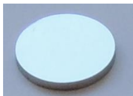
Slika 28. Uzorak nehrđajućega čelika AISI 316L prije nanošenja sol-gel YSZ filmova.
