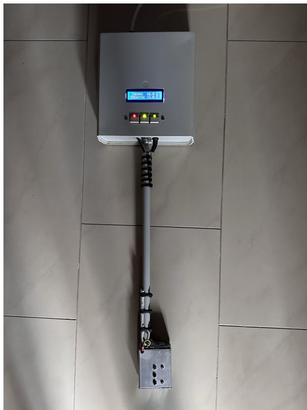
Slika 1.1: Regulator viskoznosti meda
