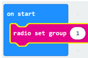
Slika 18 Blok kod za postavljanje grupe za radio komunikaciju micro:bitova
