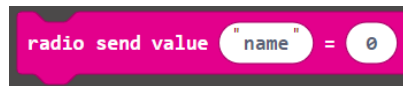
Slika 19 Naredba koja šalje specifične vrijednosti s jednog micro:bita na drugi putem radio veze
