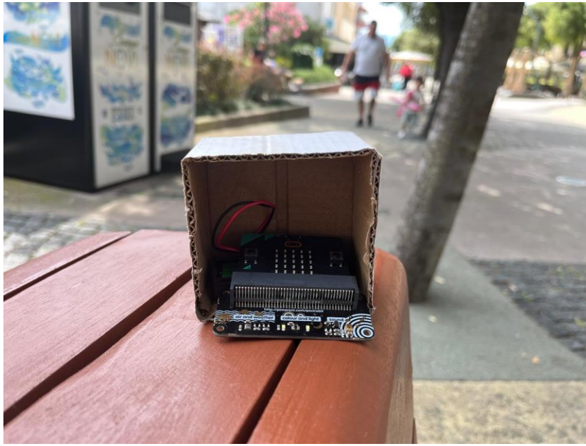
Slika 36 Micro:bit sa priključenim enviro:bitom u hladu gradske šetnice
