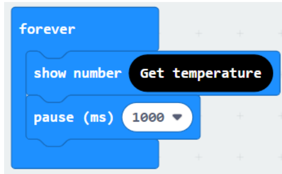
Slika 9 Kod za prikaz izmjerene temperature okoline pomoću enviro:bita
