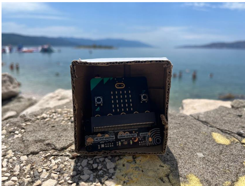
Slika 30 Micro:bit sa priključenim enviro:bitom na osunčanom dijelu plaže
