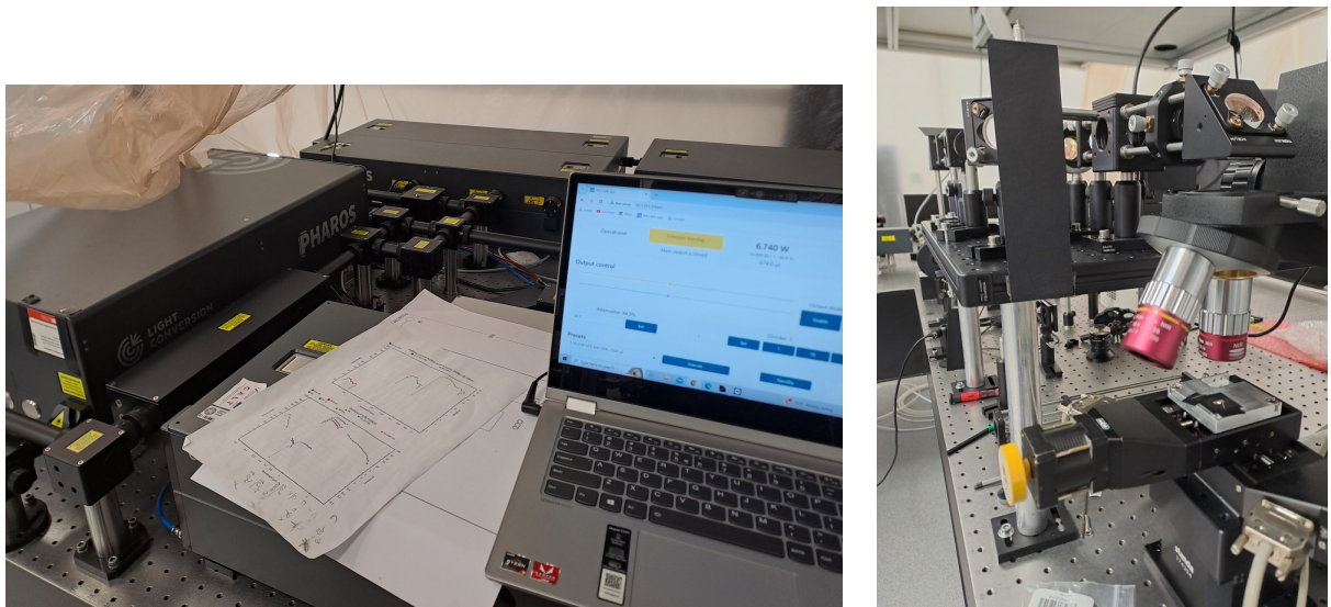
Slika 5.5: Lijevo: Pharos femtosekundni laser i program za kontrolu na računalu. Desno: Laserske zrake se usmjerava i fokusira kroz optičke komponente od kojih je zadnja objektiv s povećanjem 5 puta i na kraju upada na uzorak koji se nalazi na pomičnom postolju. U pozicioniranju uzorka pomaže snop bijele svjetlosti i kamera kojima možemo pratiti ablaciju.
