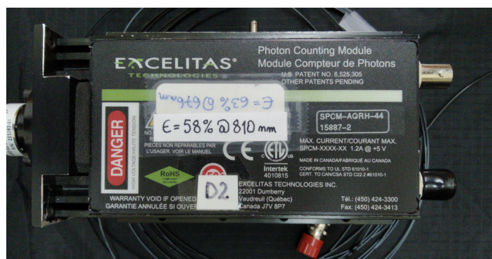
Slika 3.11: Pomoćni detektor proizvođača Excelitas Technologies korišten za potrebe kalibracije predajnog dijela QKD.
