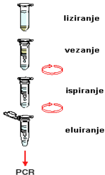
Slika 19 . Shematski prikaz postupka izolacije DNA metodom Nucleospin.
