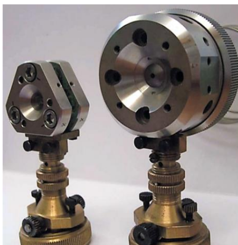
Slika 8. Merrill-Bassettova dijamantna ćelija (lijevo) i dijamantna ćelija s plinskom membranom i berilijevim pločama (desno). 65
