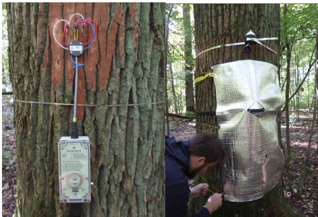
Slika 11. Dataloger priključen na čelične pločice s elektrodama i zaštitna folija od vanjskih utjecaja
