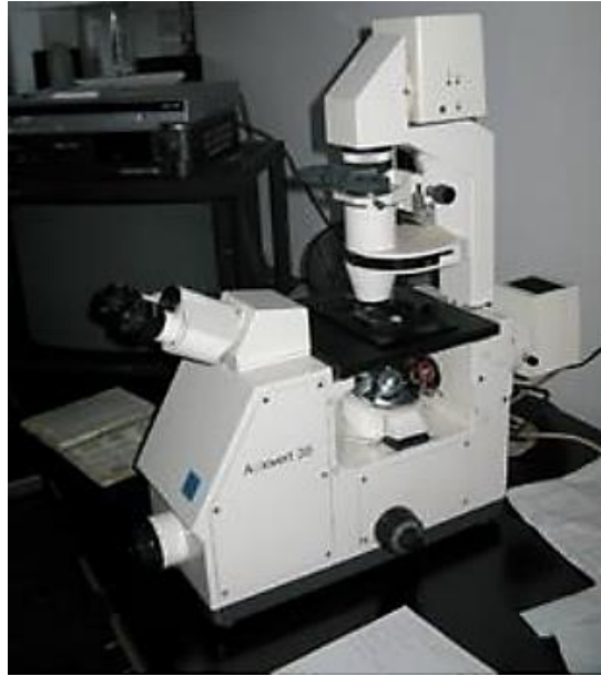
Slika 11. Invertni mikroskop Zeiss Opton Axiovert 35 korišten za pregledavanje i prebrojavanje svojti iz vodene suspenzije uzoraka. (preuzeto s: pmf.unizg.hr )
