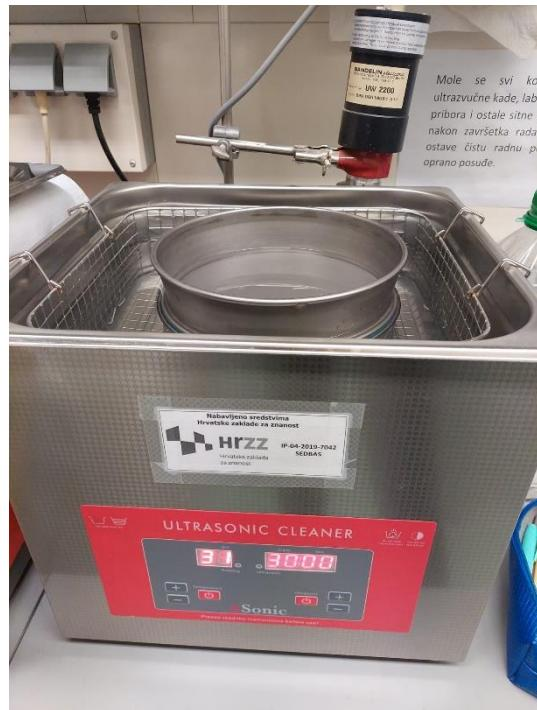
Slika 13. Ultrazvučna kadica za čišćenje sita
