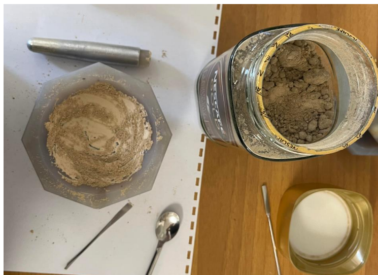
Slika 17. Priprema uzorka za analizu cjelovitog uzorka (WR) u ahatnom tarioniku
