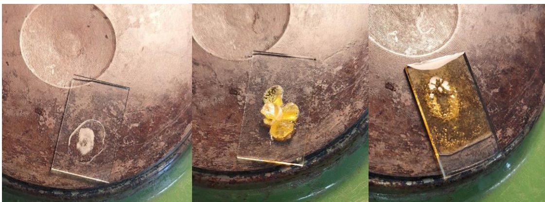
Slika 16. Proces pripreme preparata: uzorak prebačen na stakalce u kapljicu destilirane vode koja isparava (lijevo), nakon isparavanja vode se postavlja kanada balzam koji se počinje zagrijavati (sredina) te se zagrijavanjem kanada balzam topi (desno)
