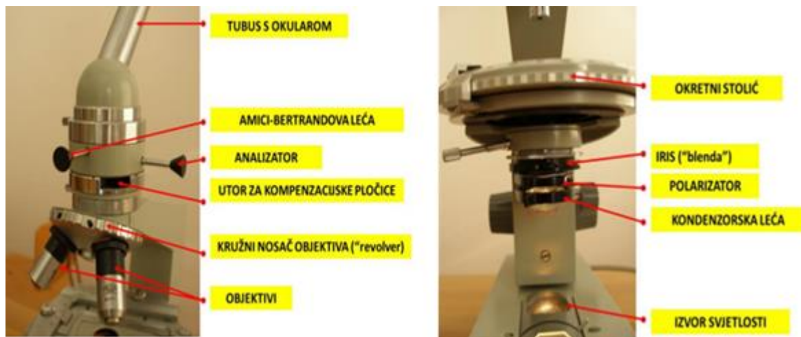
Slika 10. Prikaz optičkih komponenti polarizacijskog mikroskopa smještenih ispod okretnog mikroskopskog stolića
