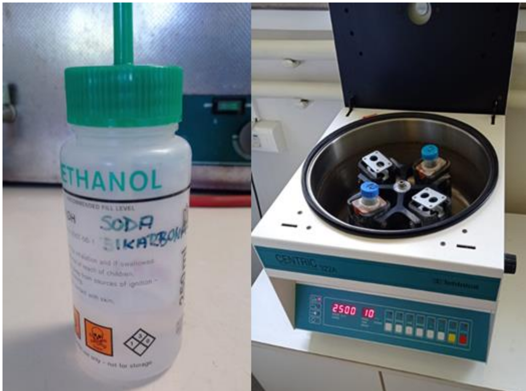
Slika 6. Postupak centrifugiranja sa sodom bikarbonom na 2500 okretaja u minuti (Izvor: vlastite fotografije)
