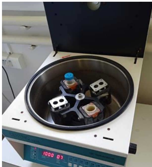
Slika 5. Postupak centrifugiranja na 1000 okretaja u minuti (Izvor: vlastita fotografija)
