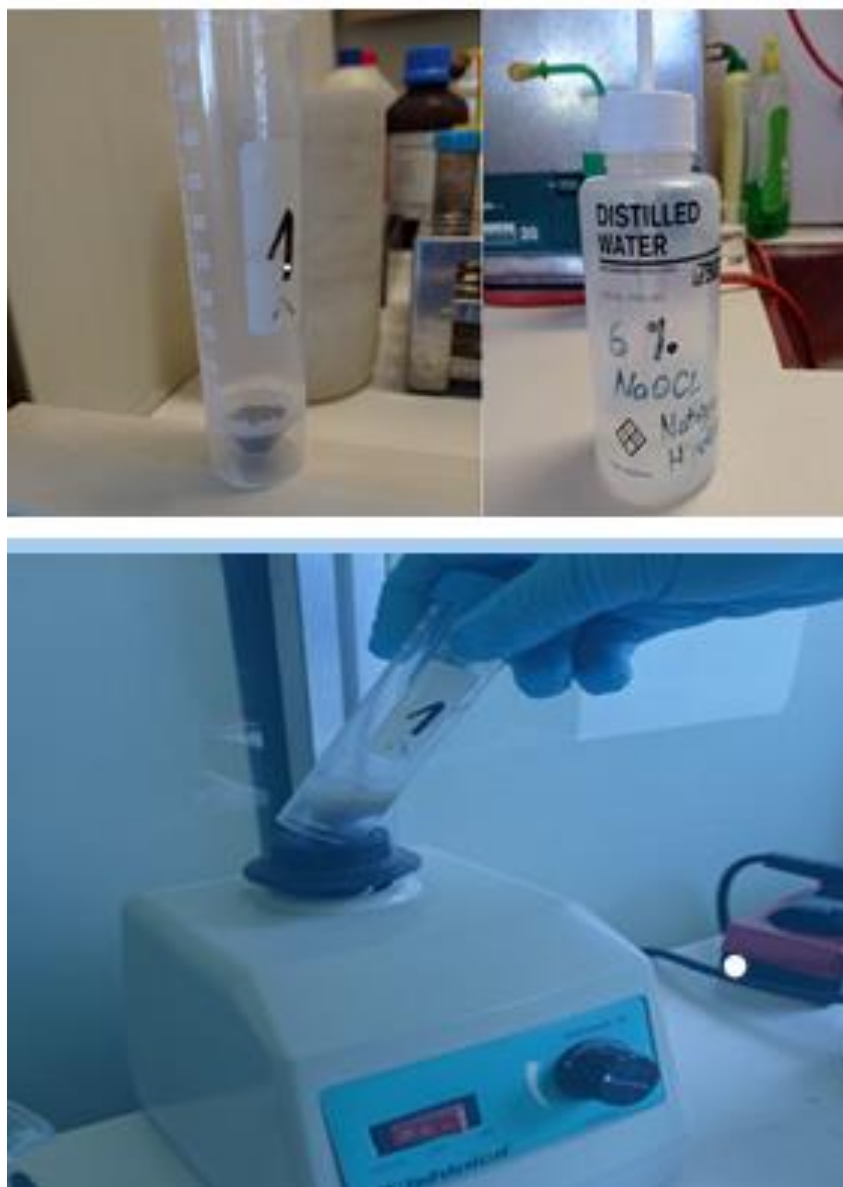
Slika 3. Priprema uzorka za analizu na miješalici (Izvor: vlastite fotografije)
